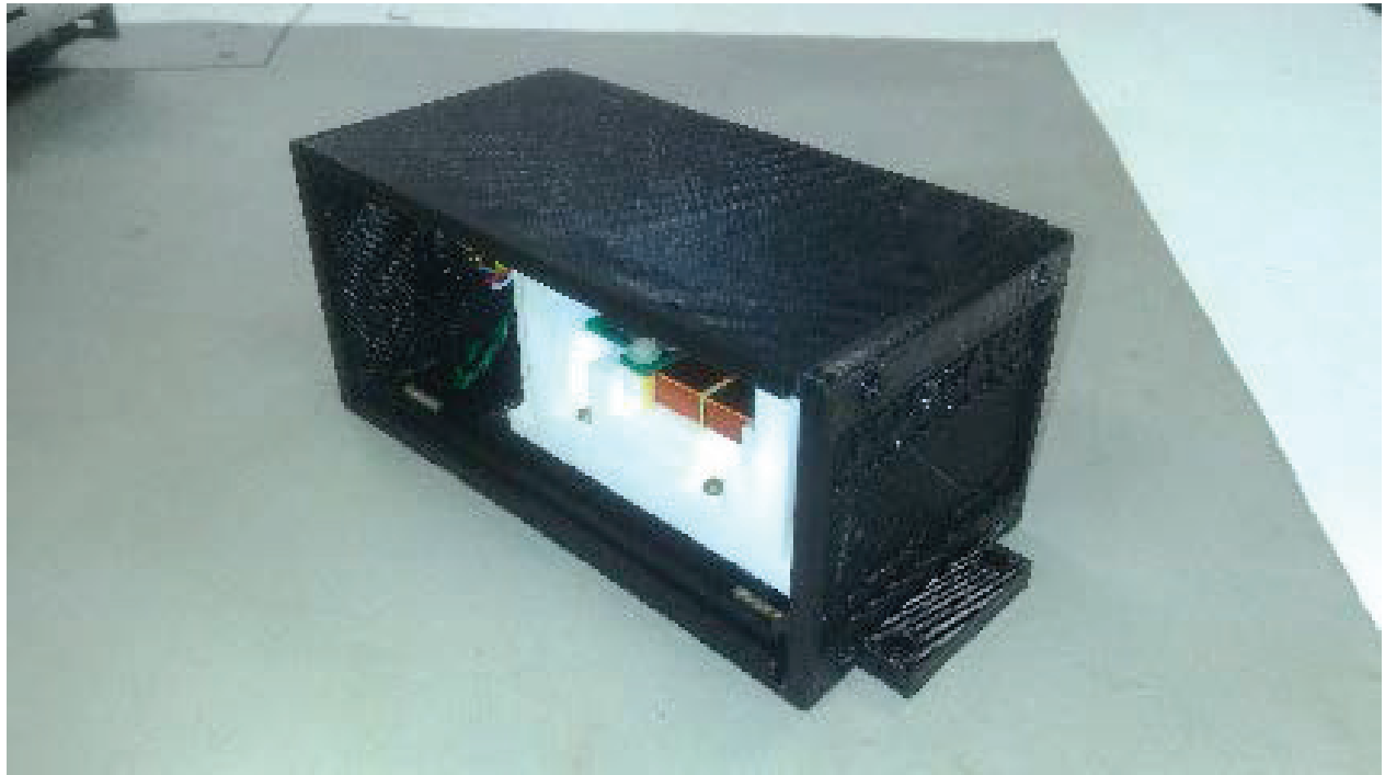
Figura 1 – Protótipo do sensor fluxgate do LDSM para uso em observatórios
